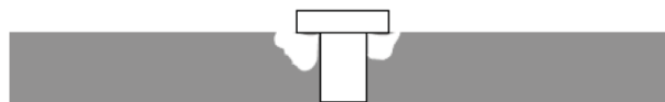
Figur 4. Sammenkobling av en edel bolt i et mindre edelt materiale. Omfanget av korrosjon i en elektrolytt med henholdsvis god og dårlig ledningsevne er illustrert
