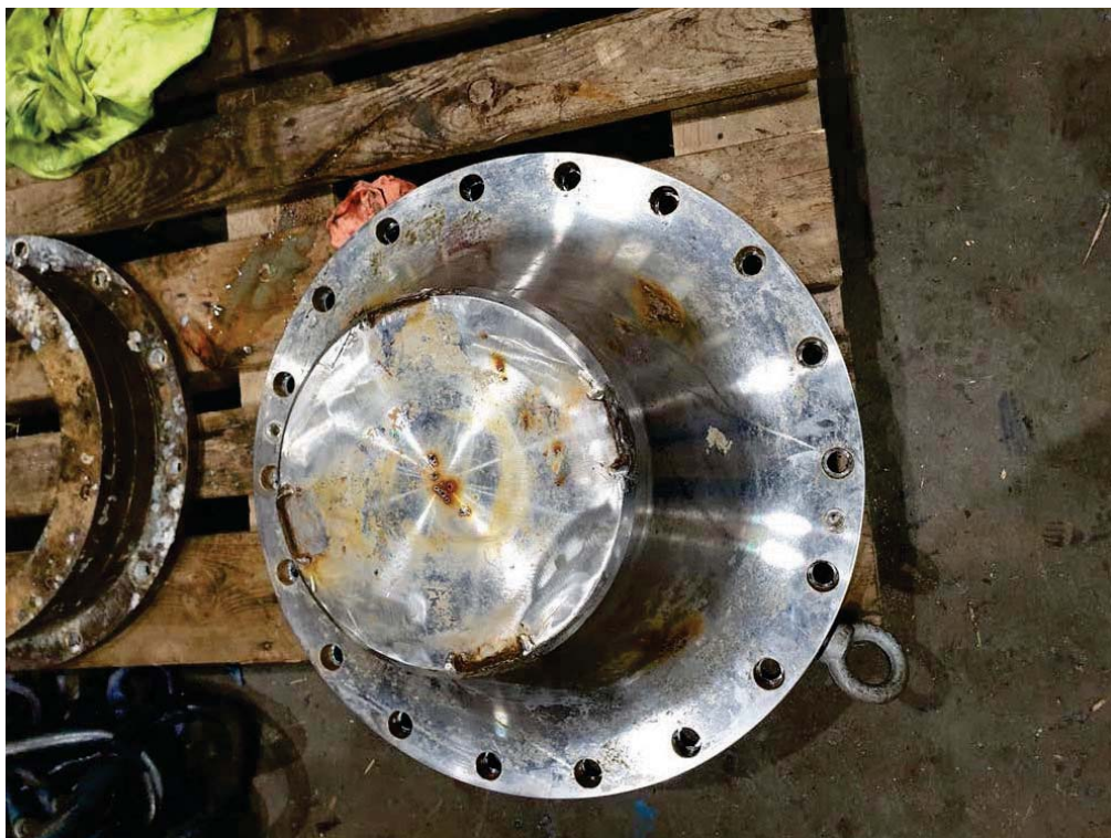
Figur 11. Dårlig innfestet anode har falt av rustfri kapsel for propell
