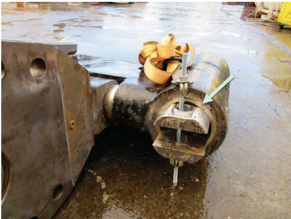
Figur 18. Ferdig montert rør med rørflaps og bronseforing i lenkeforbindelsen markert med pil
